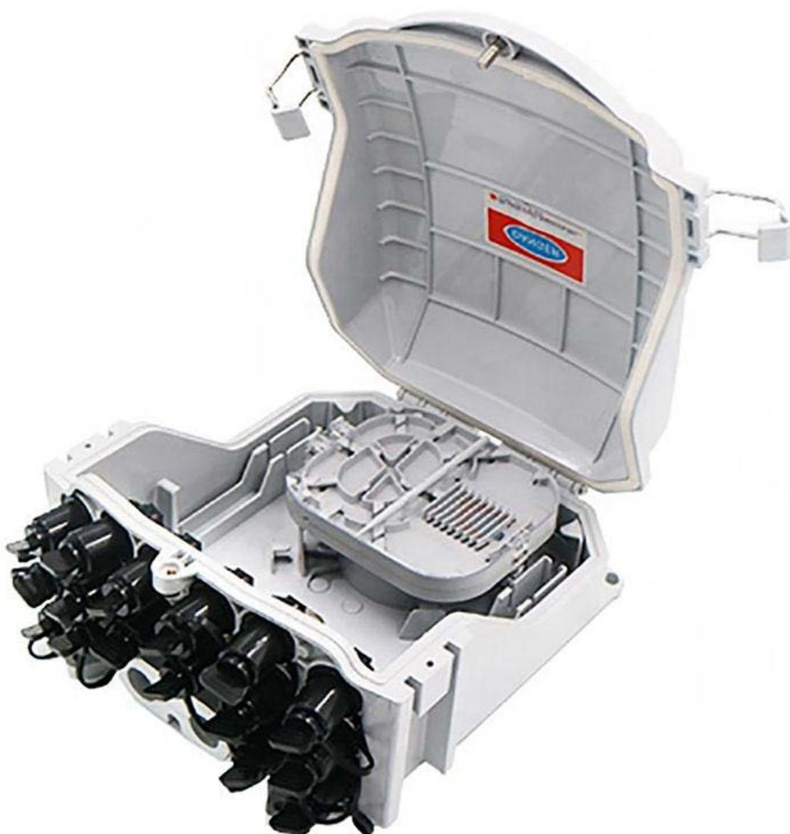
Box di distribuzione utilizzato come punto di terminazione per collegare il cavo di alimentazione al cavo di discesa nel sistema di rete di comunicazione FTTx. E' possibile eseguire giunzioni, divisioni e distribuzione delle fibre, fornendo allo stesso tempo una solida protezione e gestione per l'edificio della rete FTTx.
